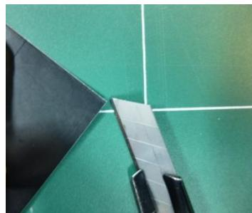
写真 1. カッター刃をアプリケーションテープと着色フィルムの間に差し込む
