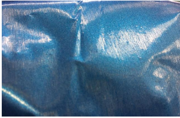
写真1：加熱し急激に伸ばした場合の粘着剤ずれの様子(ぶつぶつ状の凸が見られる)
