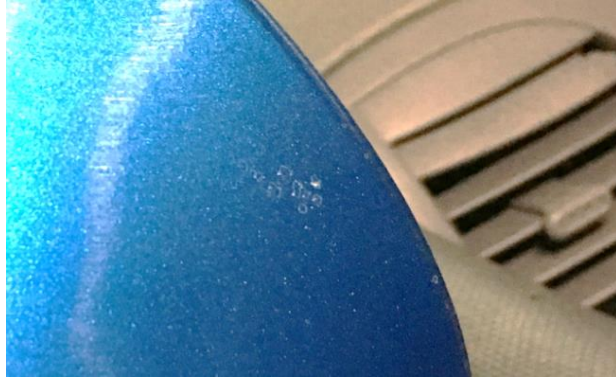
写真2：過度に加熱した場合のフィルム表面破れの様子
